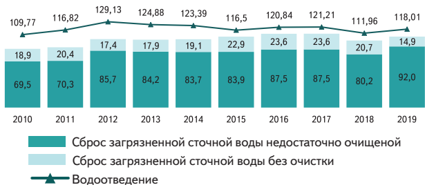
Рисунок 14.2.15 – Водоотведение и сброс загрязненных сточных вод, млн м 3
